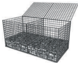
6 Remplir le gabion
